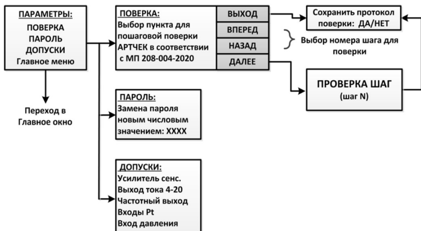
Рисунок Г.2 – Структура дополнительных меню, используемых для проверки и настройки работы устройства Артчек
