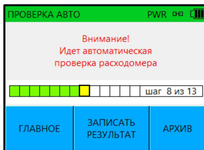
Рисунок Г.5 – Вид окна ПРОВЕРКА АВТО
